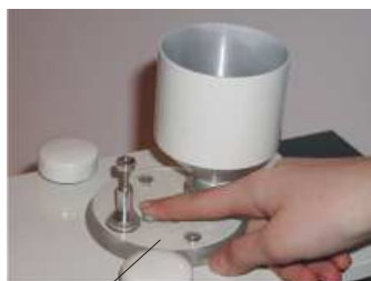
Рис. 5 Очистка камеры дозатора
