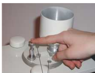
Рис. 6 Очистка размольной камеры и продуктопровода
