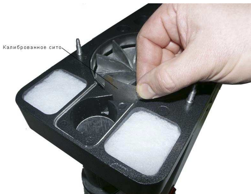
Рис 8. Установка и замена калиброванного сита
