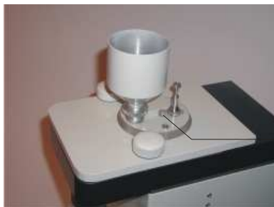
Рис. 7 Переустановка автоматического дозатора в ручной режим
