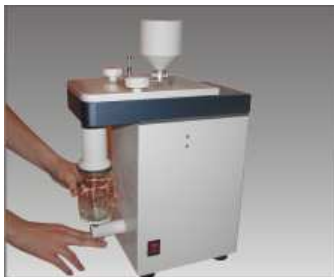
Рис. 4 Установка и снятие приемной емкости
